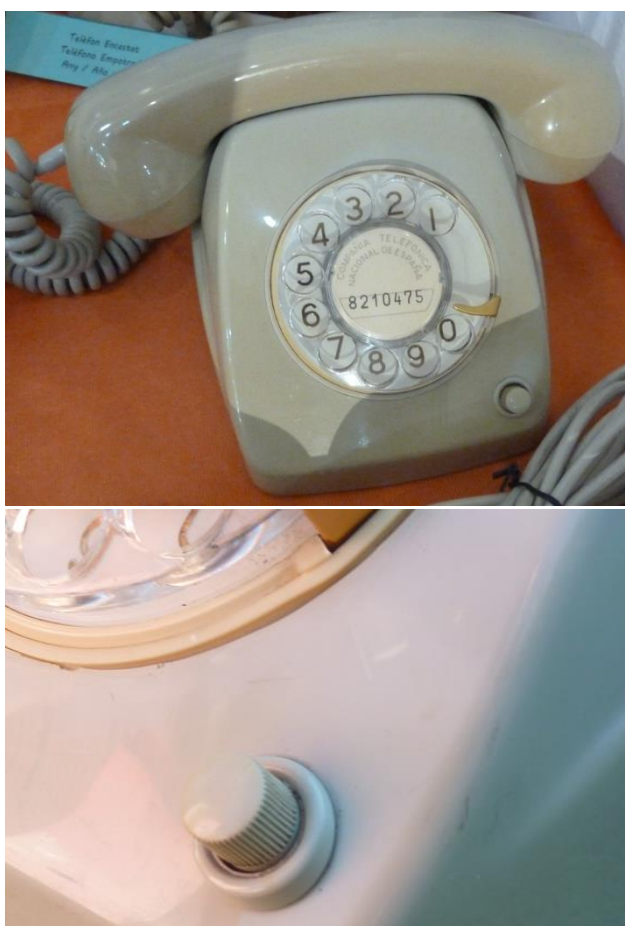
Destacado 7 Heraldo con ajuste de volumen en la carcasa
