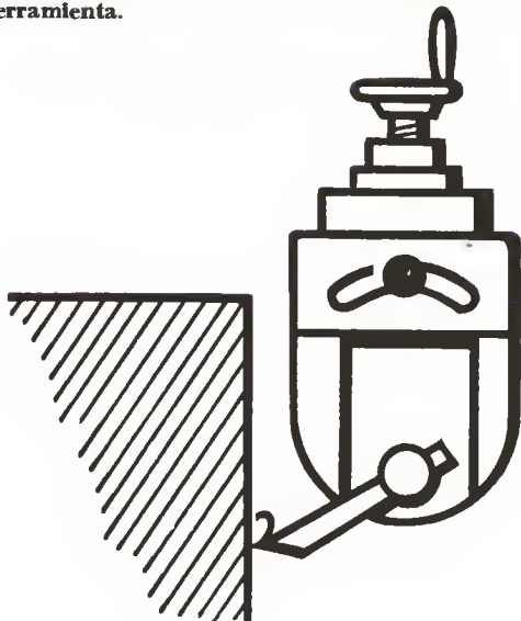
Husillos para el movimiento de avance de la herramienta.
