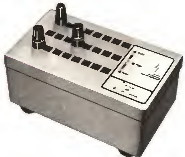
Resistencias adicionales AEG para medir tensiones en c.c.
