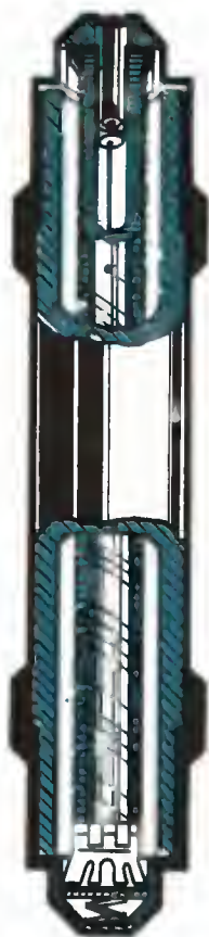
Bases de cortacircuitos Gardy para montaje exterior
