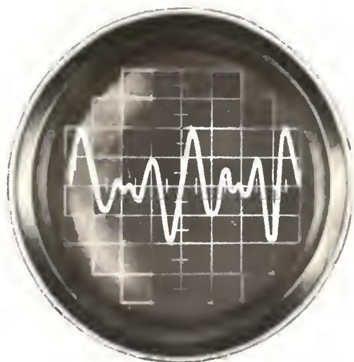
Oscilograma de la nota Do, producida por un piano.
