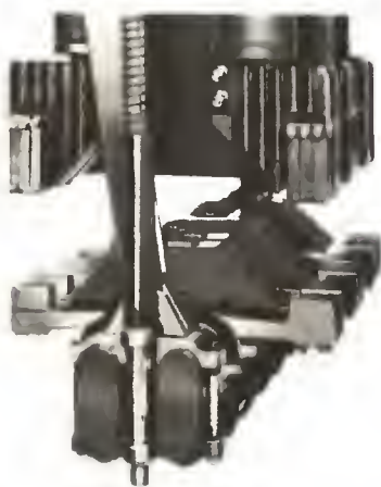
Dispositivo de contacto para grandes intensidades, con contactos principales de muelles y dedos de contacto como contactos apagachispas.
