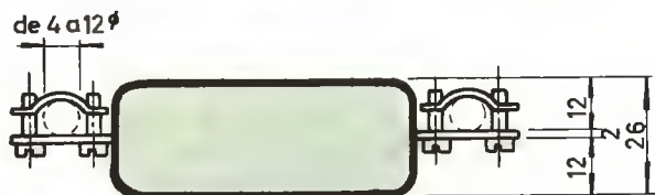
Dimensiones del pararrayos Re-var para líneas de baja tensión.
