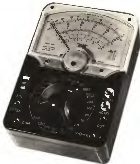
Fotografía de dos instrumentos universales de medida. El de la izquierda (fabricación italiana) consigue los distintos alcances mediante hembrillas. El de la derecha es un instrumento japonés cuyos distintos alcances se establecen por medio de un conmutador.
