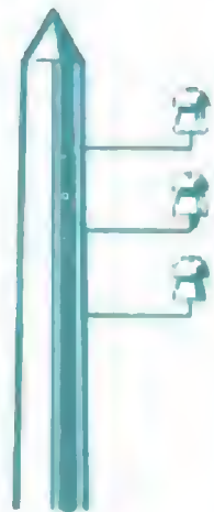
Poste de madera. Montaje en bandera.
