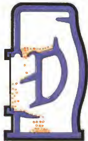
Sección de la boca artificial usada por la Sociedad Siemens y Halske para el ensayo rápido de los micrófonos y los receptores.
