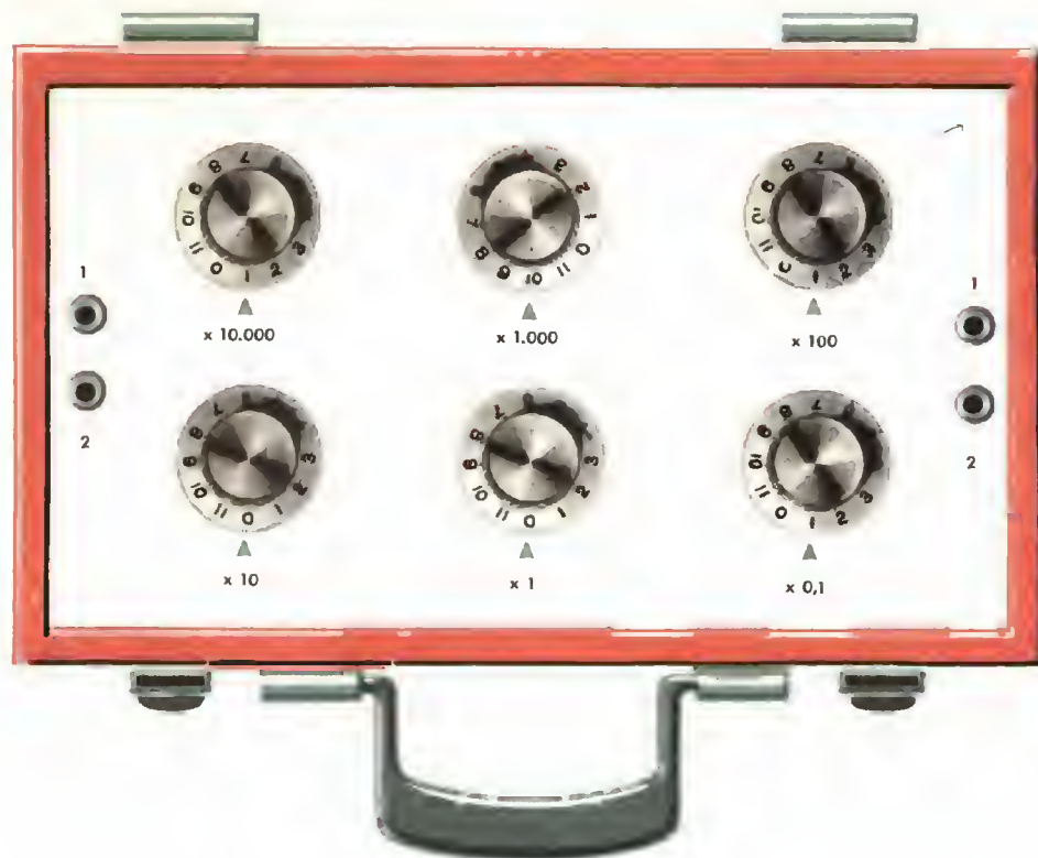
Vista del panel superior de una caja de resistencias con conmutadores. La lectura total posible con esta caja sería de 20.100'1 ohmios.
