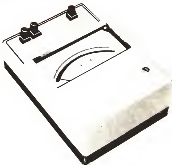
Miliamperimetro y voltimetro, clase 0'2: error de 0'2 % de la desviación total de la escala. Es un aparato de bobina móvil para corriente continua.
