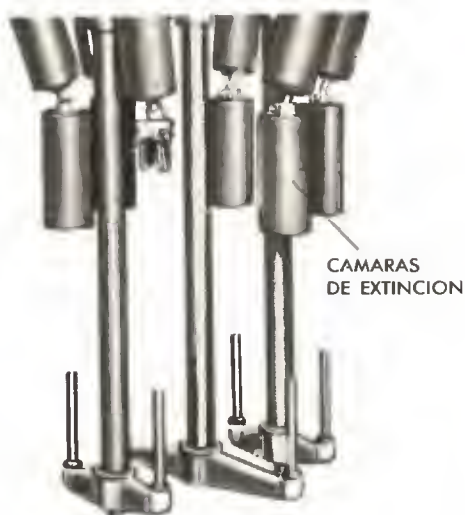
Dispositivo de contacto, con cámaras de extinción para interruptores de alta potencia.
