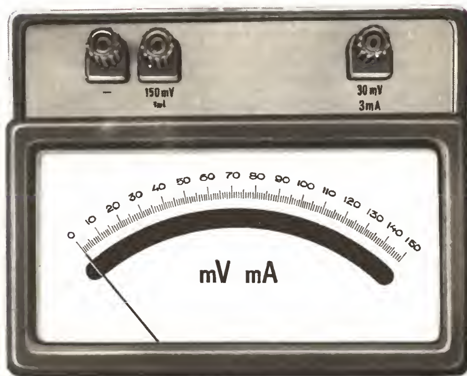
Volt-amperimetro de laboratorio. Precisión: 0'2 % del total de la escala.
