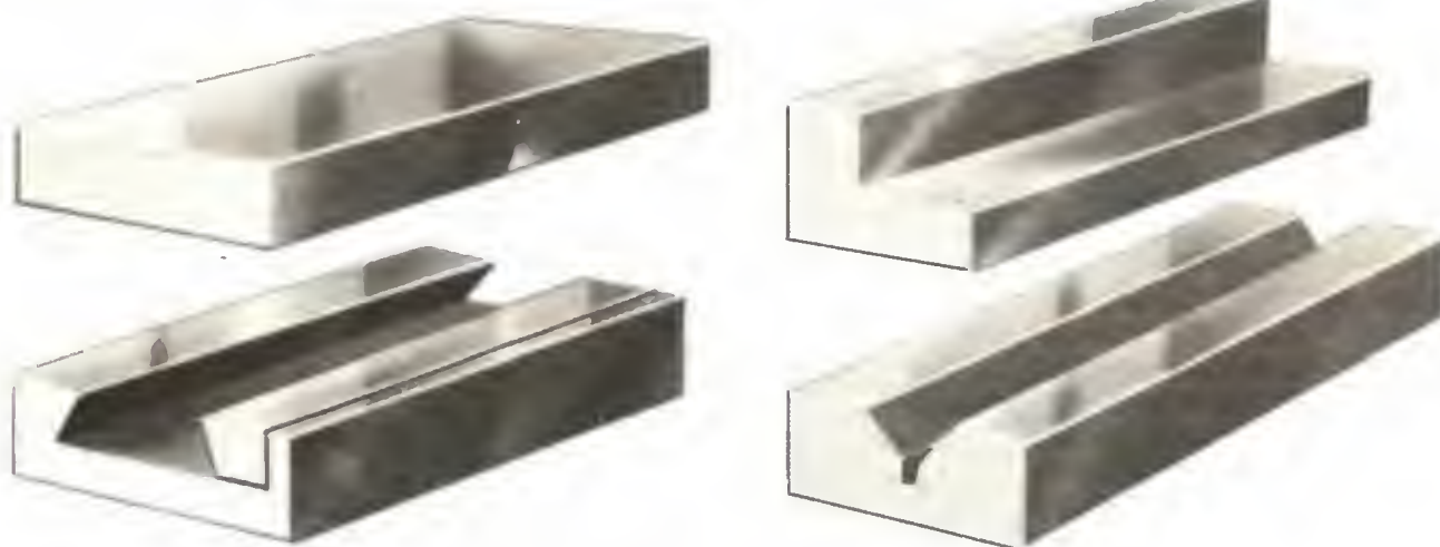
Operaciones características de la limadora.
