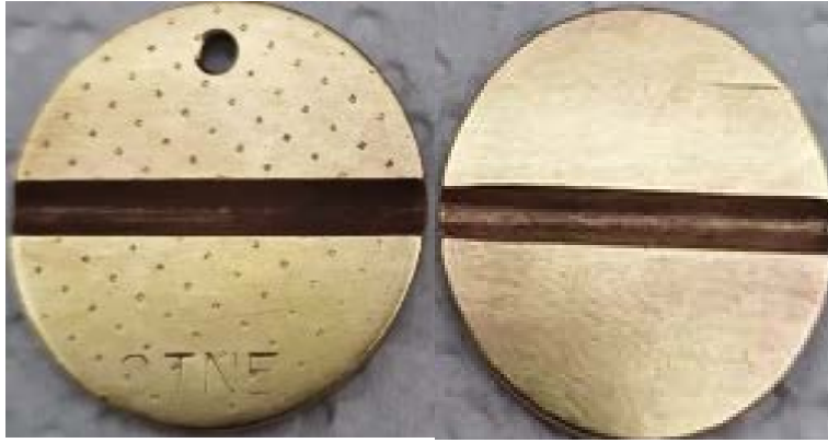
DOS RANURAS, UNA EN CADA CARA. CENTRADAS Codificación: 2RC
