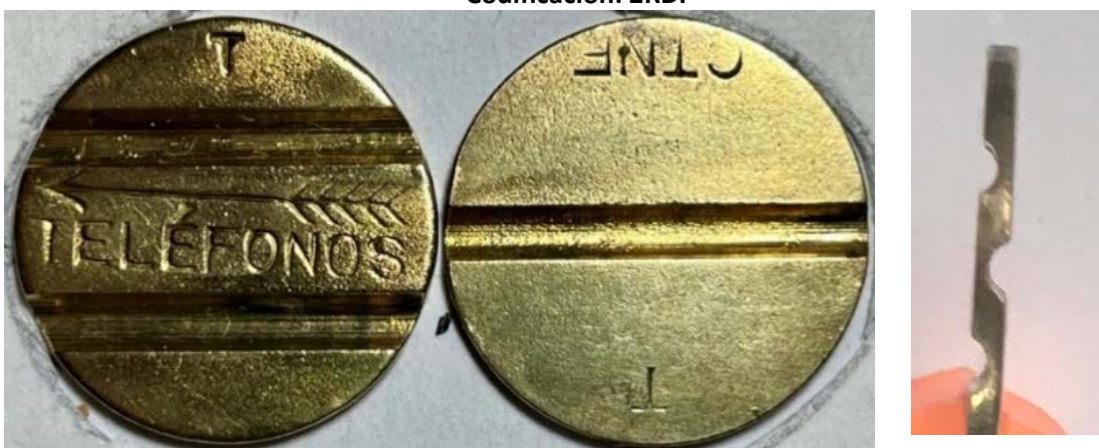
TRES RANURAS, DOS EN CARA PRINCIPAL Y UNA EN CARA TRASERA Codificación: 3R
