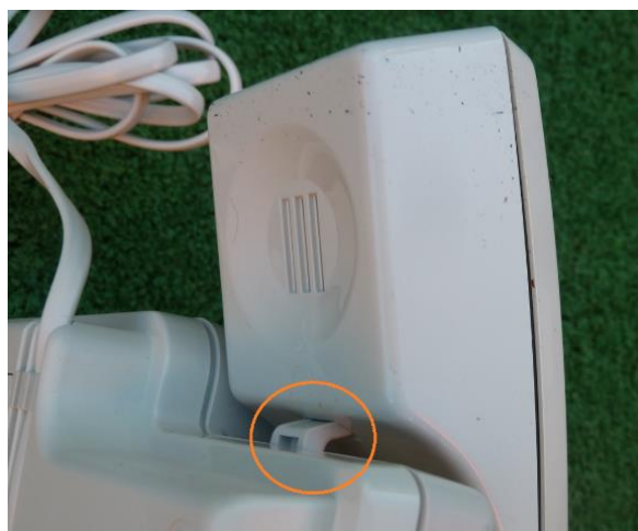
Fig. 19 Teléfono Astral Pestaña sujeción microteléfono
