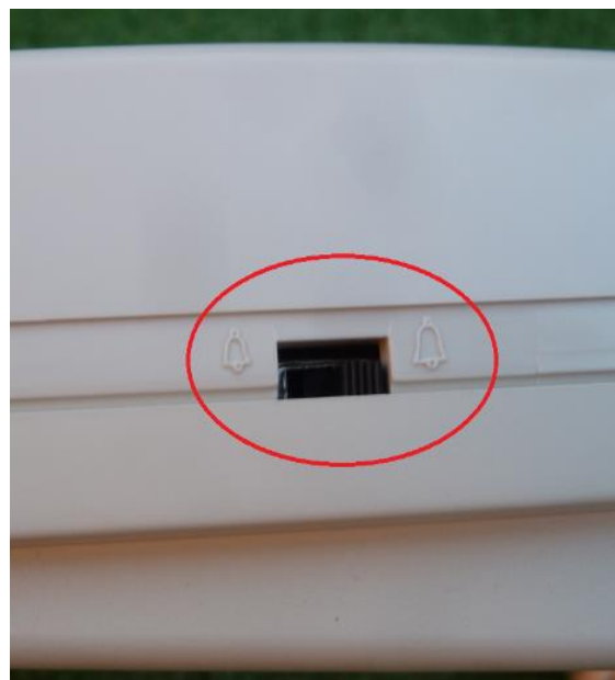
Fig. 17 Teléfono Astral selector volumen timbre
