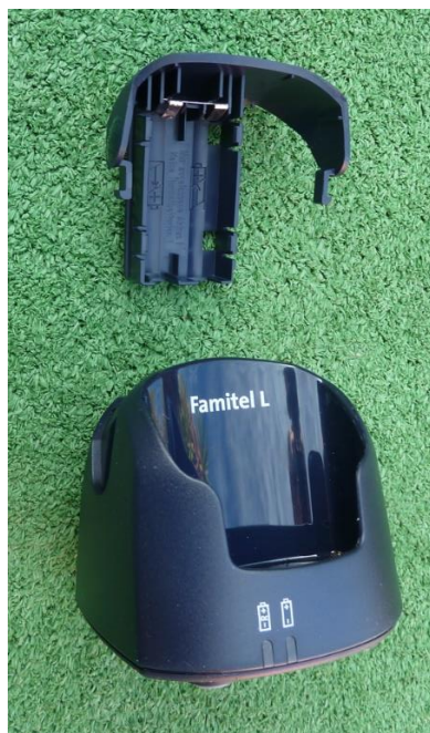
Fig. 72 Compartimento carga baterías aux.
