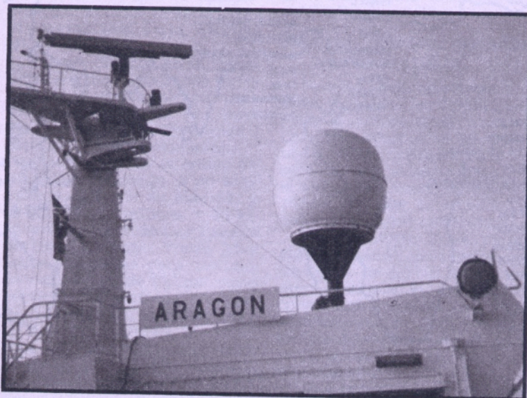
Antena del equipo de comunicaciones por satélite instalado en el petrolero «Aragón», primer buque mercante español dotado de este modernísimo sistema Magnavox-HRM
