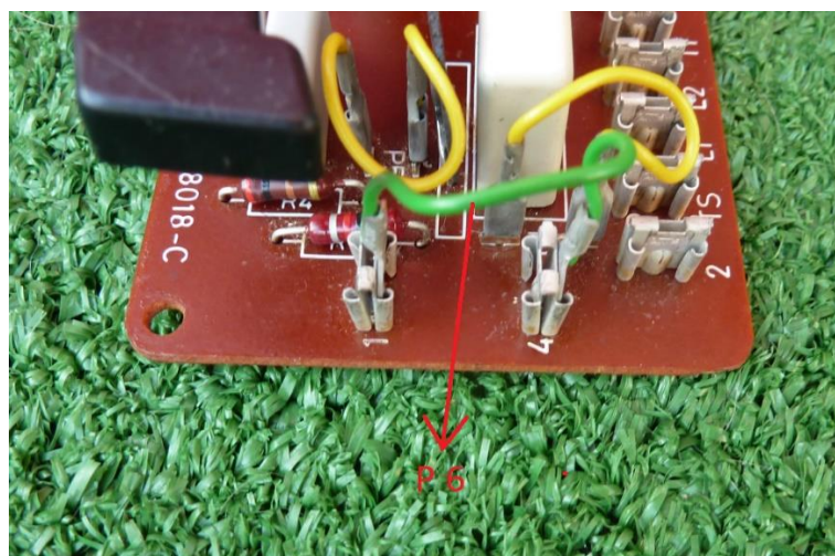
Ilustración 143 "P 6" Se realiza entre los terminales 1 y 4, puente en color verde.
