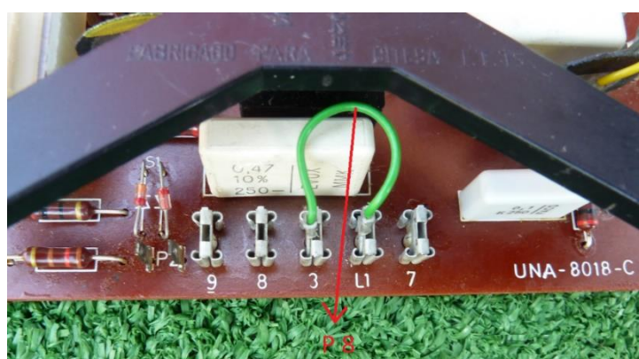
Ilustración 145 Puente "P 8" Se realiza entre los terminales 3 y L1, puente en color verde
