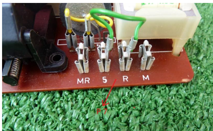
Ilustración 144 "P 7" Se realiza entre los terminales 5 y R, puente en color verde.
