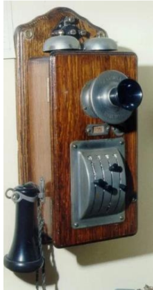
Ilustración 2 Teléfono de pared sistema Lorimer con pulsadores de marcación foto http://jean.godi.free.fr
