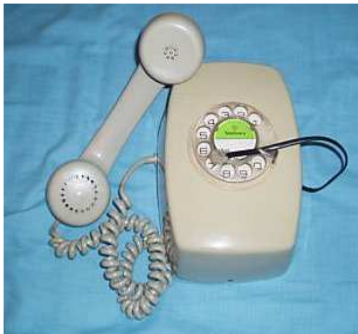
Fabricante: CITESA Año: 1963 Aparato mural modelo “Heraldo” con disco y batería central. 2
