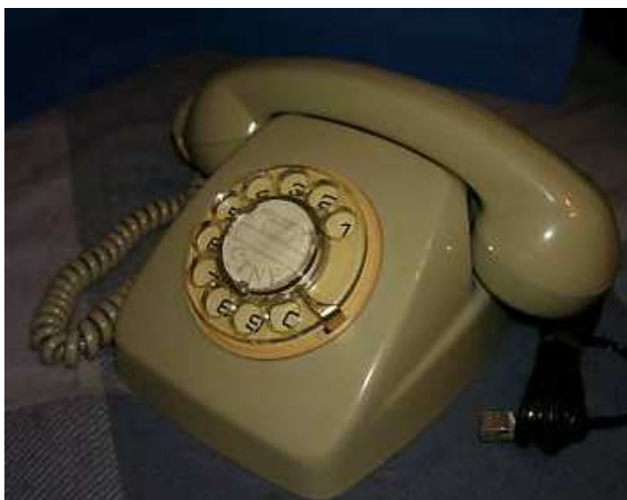
Fabricante: CITESA Año: 1963 Aparato sobremesa modelo “Heraldo” con disco y batería central. 2
