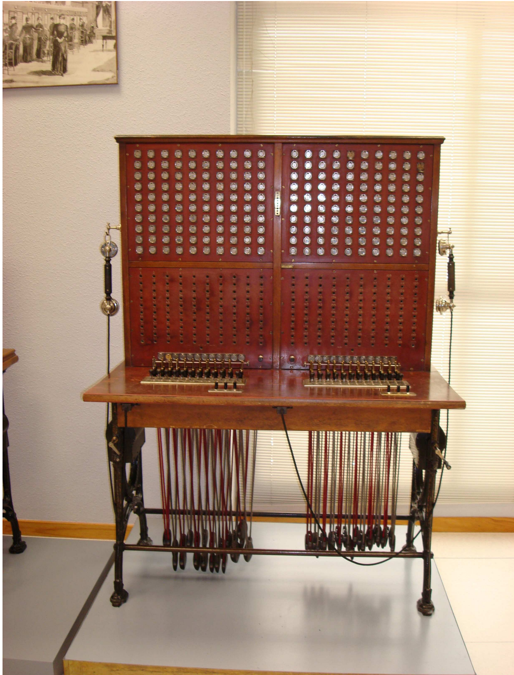
Centralita de batería central de 200 abonados fabricada por L.M.Ericsson (1884).
