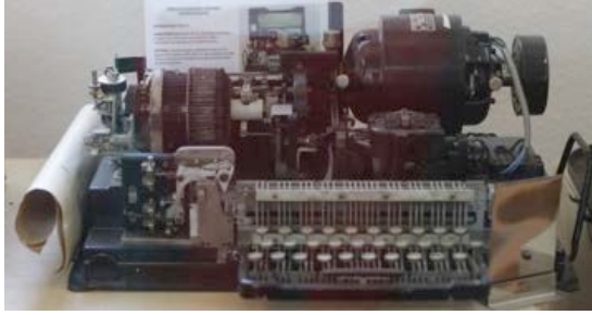
TTP02 Teletipo inglés CREED 3D ETL3-124 CREED 3D
