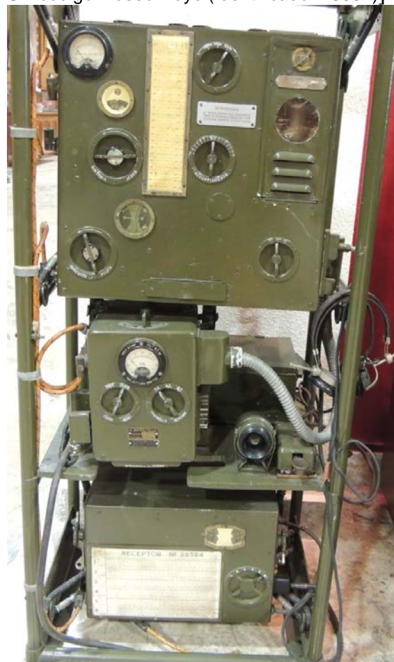
Estación de Radio tipo aviación italiana de la marca Allocchio, Bacchini & C. Está compuesto por varios elementos identificados por RA350/1-AR5-P63N
