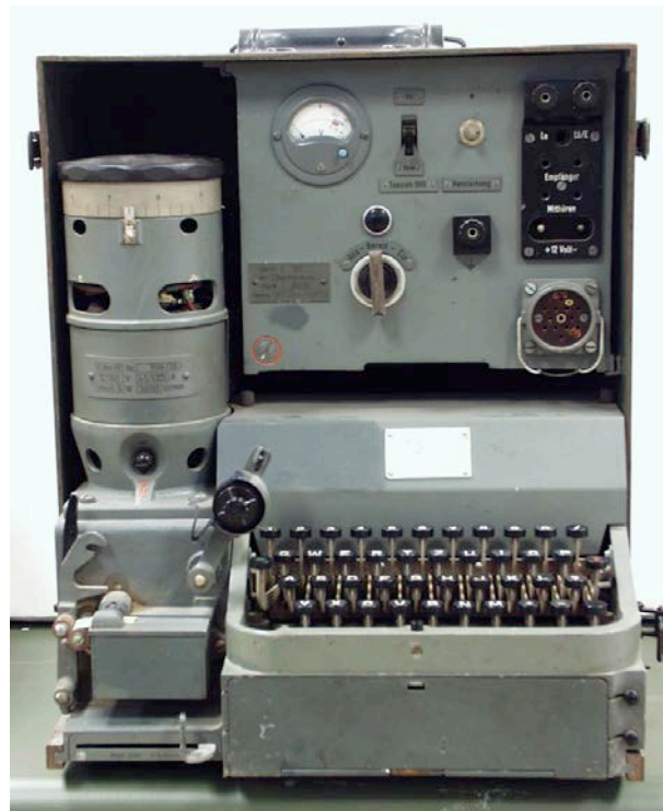
TTP03 Teletipo militar portátil Sistema HELL alemán Legión Cóndor 1938
