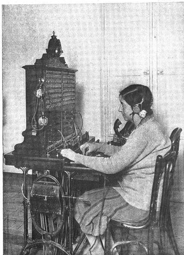
Abajo: Cuadro más moderno que instaló la Compañía para substituir a aquéllos y que también se ha retirado del servicio por haberse establecido el automático en Sevilla
