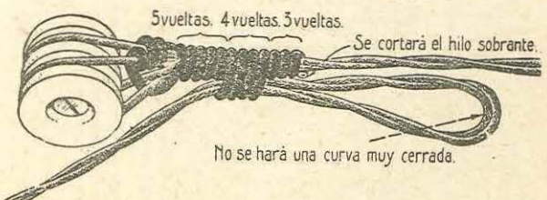
Fig. 36 Retenciones del cable de acometida
