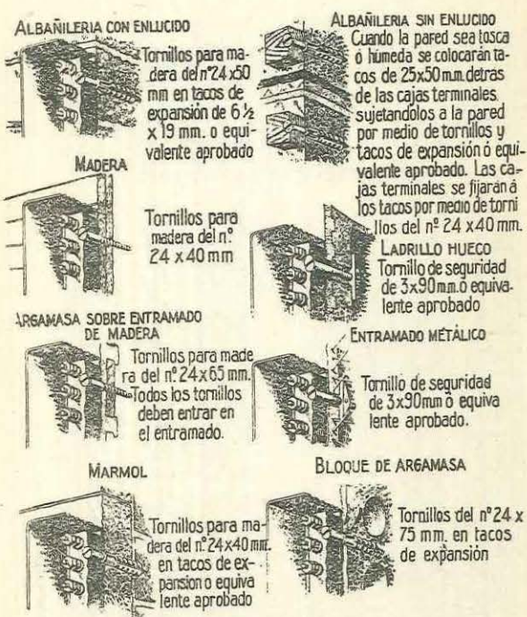
Fig. 55 Instalación de cajas terminales.
