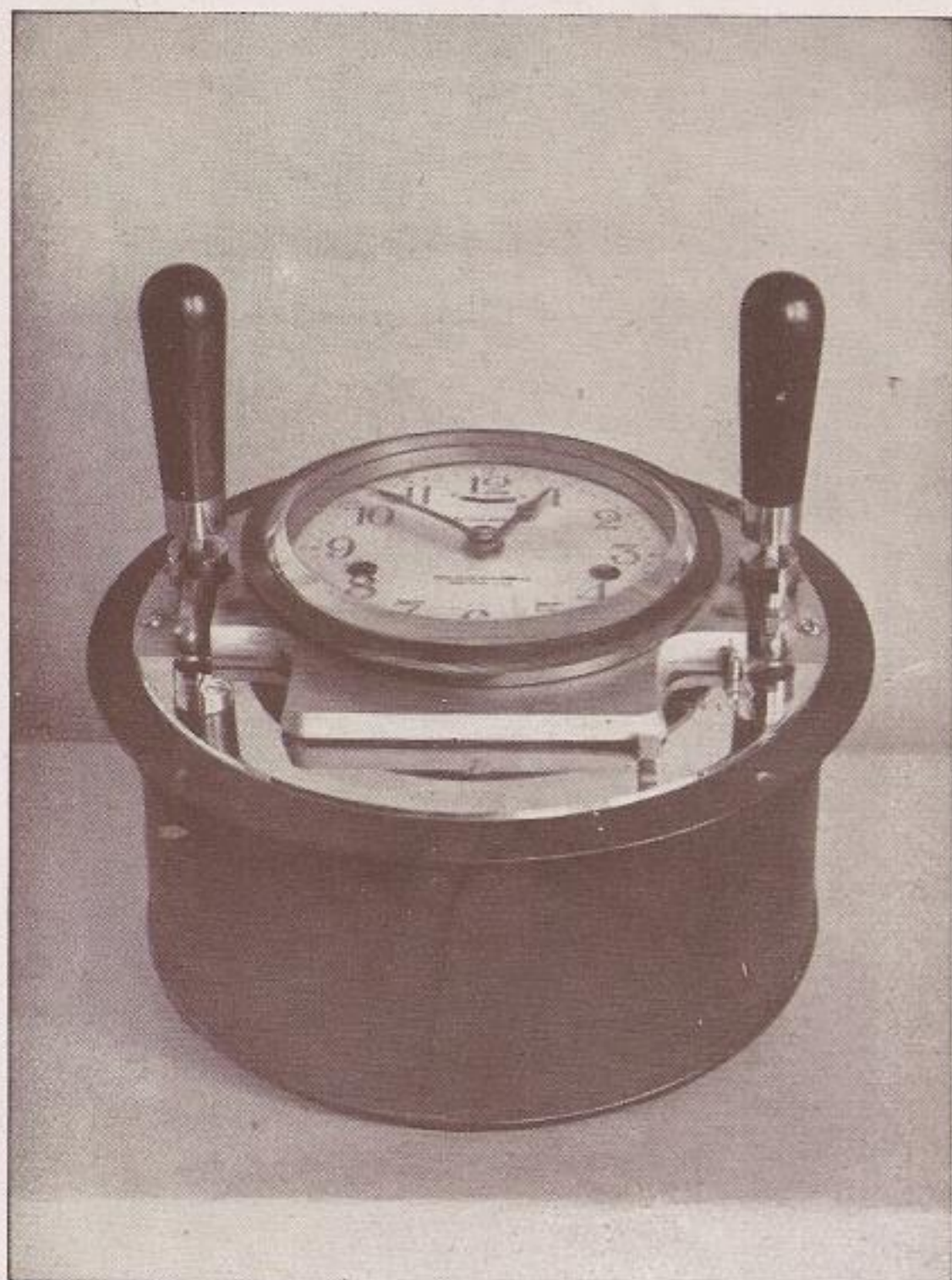
Fig. 1. a — El calculógrafo con la caja cilíndrica que resguarda el mecanismo
