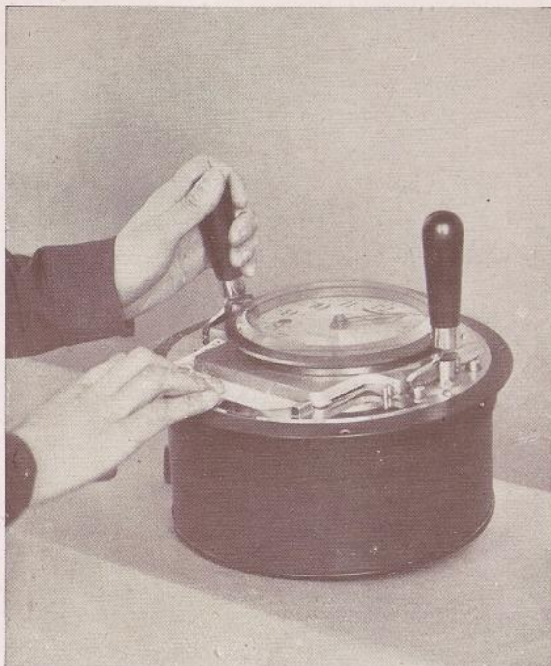
Fig. 4. — La conferencia termina. La telefonista vuelve a introducir el ticket por la ranura y mueve la palanca de la izquierda. Por esta sencilla operación queda estampada la duración de la conferencia
